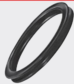
Das Dichtungsprinzip der X-Ringe entspricht in hohem Maße dem der O-Ring-Dichtung. Bei X-Ringen handelt es sich um selbsttätige, doppelt wirkende Dichtungselemente. Die Initialabdichtung erfolgt durch die Diametralzusammenpressung in einer rechteckigen Nut. Der Systemdruck selbst bewirkt dann eine zuverlässige positive Abdichtung.
